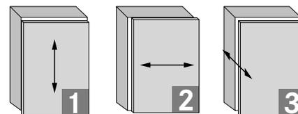
(HV) Regulación de altura +/-2 mm
